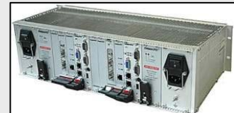
Figure 2 : ALSPA MFC3000 - Contrôleur multifonction basé sur le standard industriel
